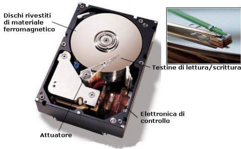
Figura 1.1: interno di un hard disk; in alto a destra: particolare della testina di lettura/scrittura
