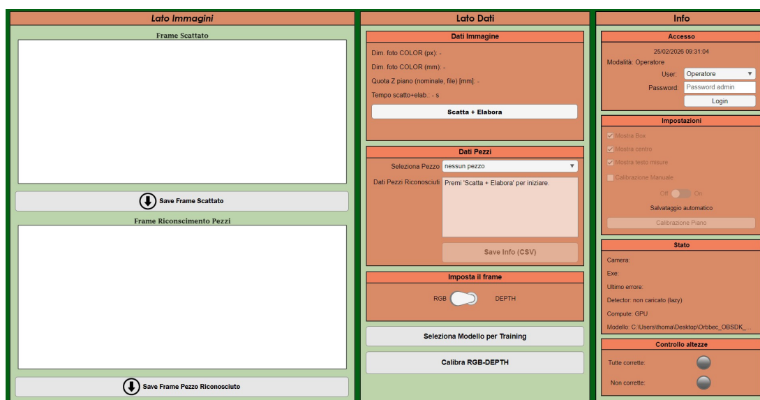
Figura 5.1: Pannello operatore sviluppato in App Designer di MATLAB.
