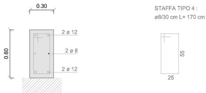
Figura 105 - Particolare di A.2001.a.sa.T01 - Fondazioni - Cordolo di collegamento
