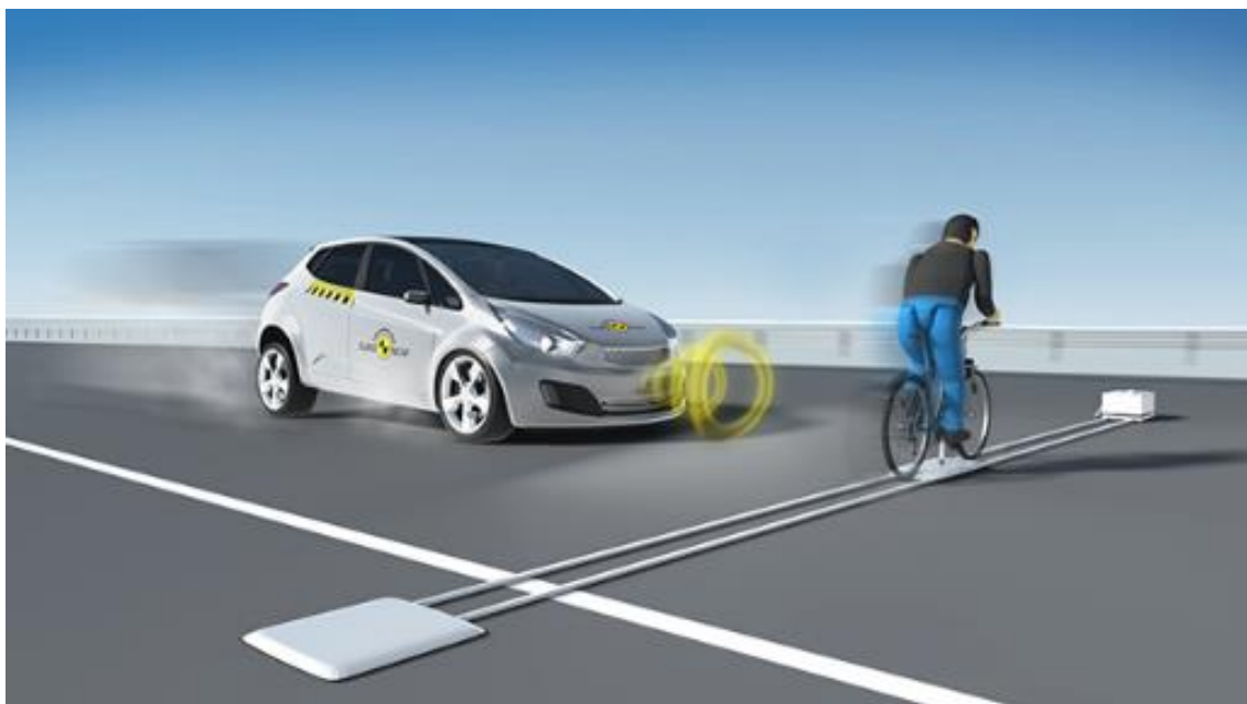
Figura 2.3: Autonomous Emergency Braking (AEB) - Frenata automatica di emergenza (Vai 2018)
