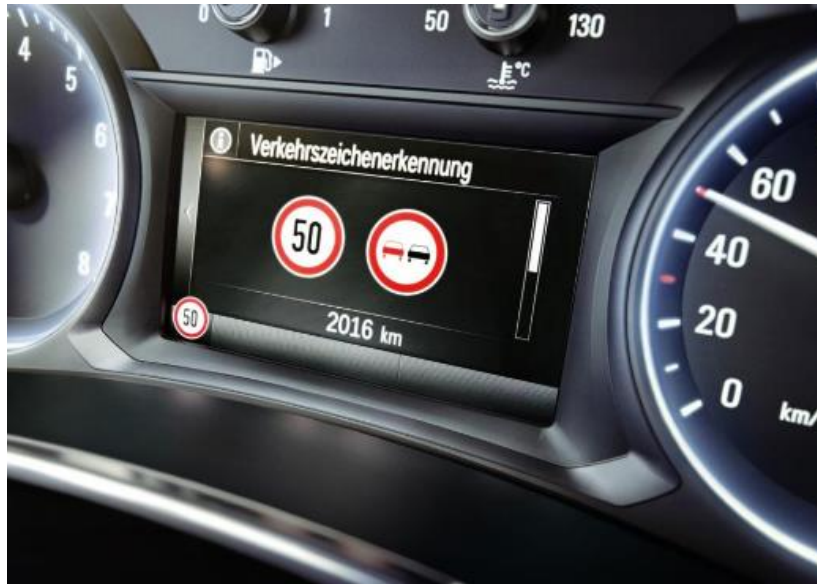
Figura 2.10: Traffic Sign Recognition (TSR) - Riconoscimento dei segnali stradali (Vai 2018)
