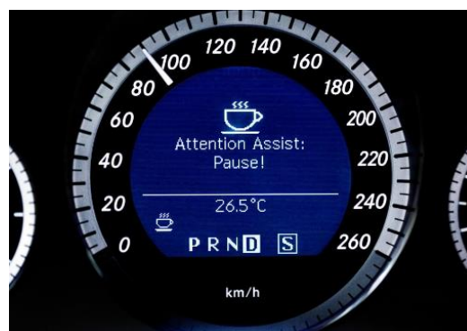
Figura 2.7: Driving Attention Assist (DAS)- Monitoraggio dell'attenzione del conducente (Vai 2018)
