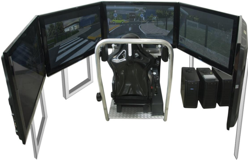
Figura 4.4: Simulatore di guida statico del Laboratorio di Trasporti del DICEA
