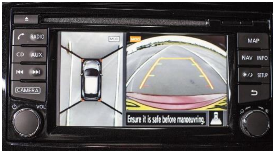
Figura 2.6: Camera Monitor System (CMS) - Monitoraggio con videocamere (Vai 2018)
