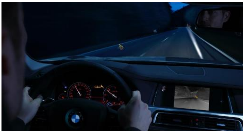
Figura 2.8: Night View Assit (NVA) - Assistente alla visione notturna (Vai 2018)
