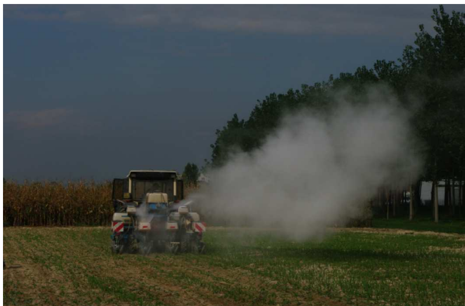
Figura 3.2.1 Nube di talco dimostrativa emessa dalla seminatrice “Monosem Plus” sul lato destro
