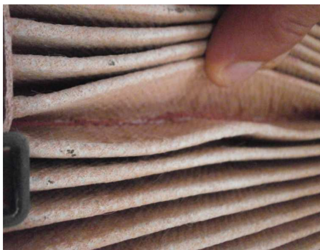
Figura 3.2.2 Immagine del filtro usato come modifica alla Gaspardo Magica
