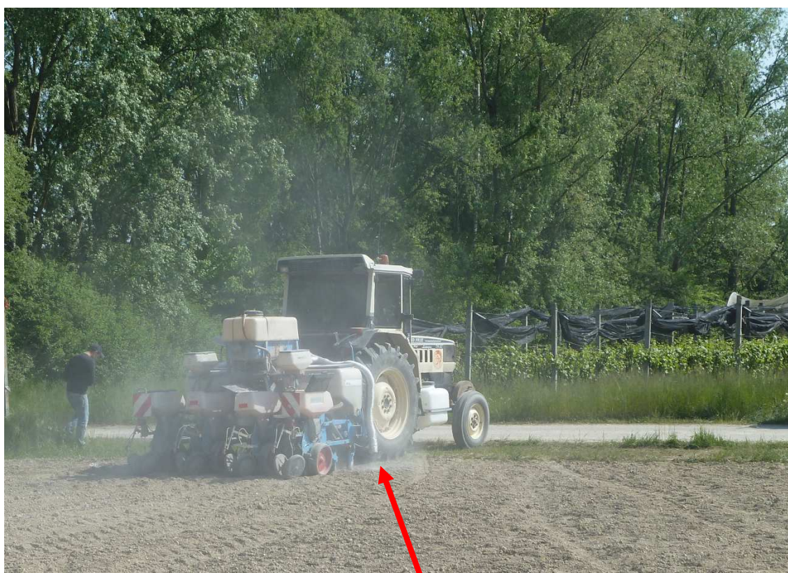
Figura 3.1.1 Seminatrice Monosem modificata (dual pipe); l'aria di scarico viene divisa in due e convogliata attraverso due tubi flessibili che la direzionano verso il suolo
