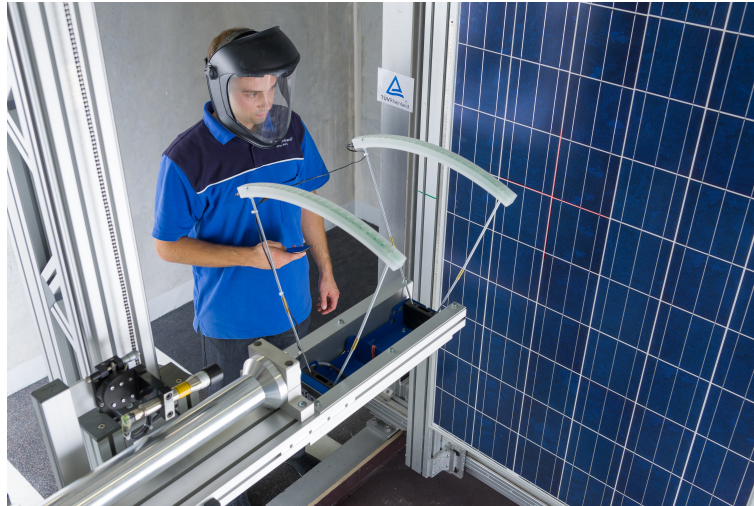
Figura 6.5: Setup per il test della grandine.
