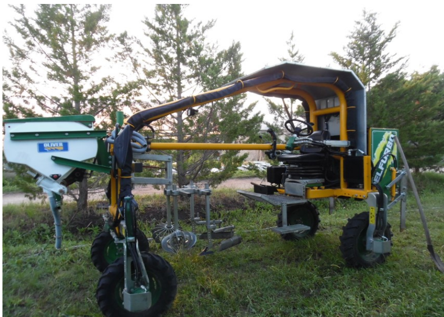
Figura 7: Sarchiatrice “El furbo”, della Oliver, usata per svolgere il controllo meccanico delle malerbe.
