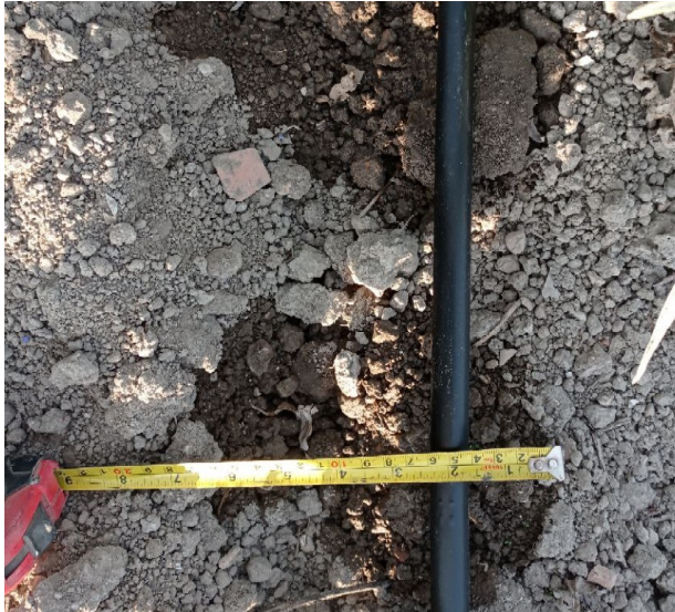
Figura 15: Ala gocciolante impiegata nella tesi e superficie bagnata dalla stessa.
