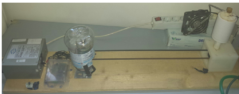
Fig. 5.18 – Sistema con motore per la rotazione del dispositivo contenente la provetta.
