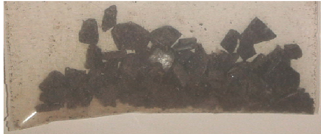
Fig. 5.1 – Campioni di NPs di \text{CoFe}_2\text{O}_4 utilizzati nelle prove di caratterizzazione.
