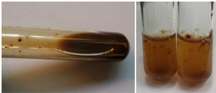
Fig. 5.40 – Fenomeni di aggregazione delle nanoparticelle nei campioni sperimentali.
