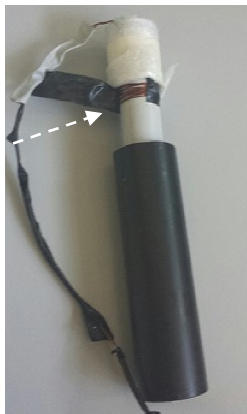
Fig. 5.21 – Bobina di raccolta (indicata con freccia tratteggiata).
