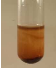
Fig. 5.39 – Deposito di nanoparticelle sul fondo della provetta.
