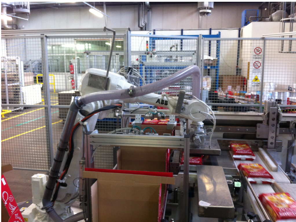
Figura 23: Robot paletizzatore IRB4600 in opera
