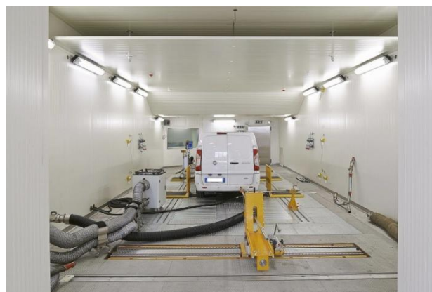
Figura 2.2. Tipico banco a rulli usato per il rilevamento delle caratteristiche meccaniche dei motori
