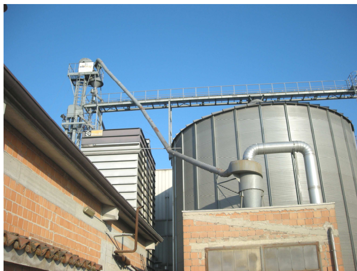
Figura 50: Pulitore ad aria e camera di raccolta degli scarti
