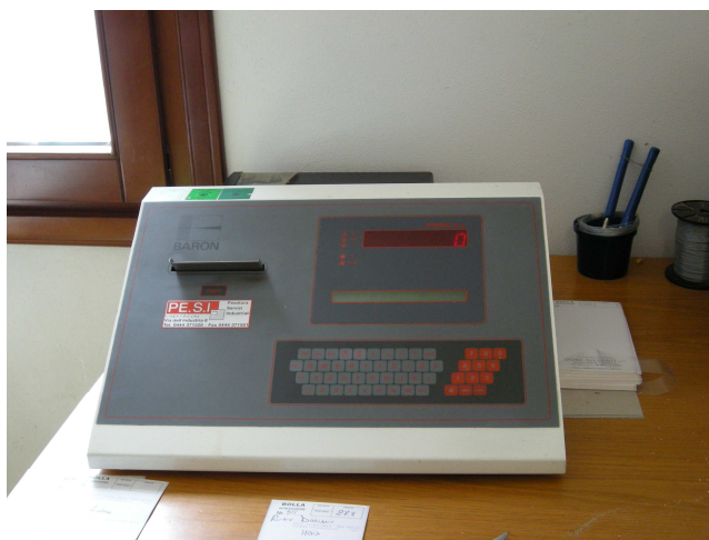
Figura 46: Apparecchio per la pesatura dei rimorchi
