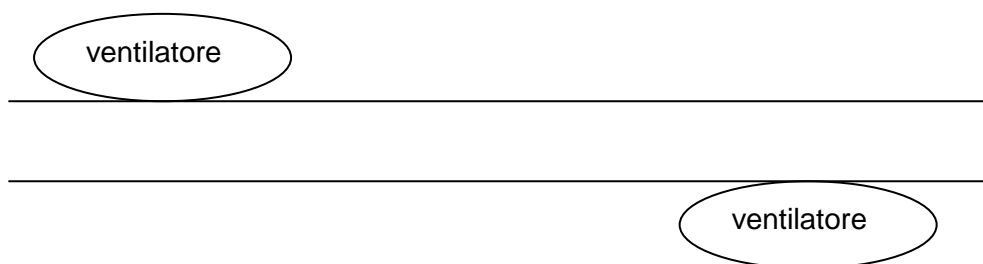
Figura 101: Collocazione dei ventilatori rispetto al tappeto dove giace il materiale nell'essiccatoio
