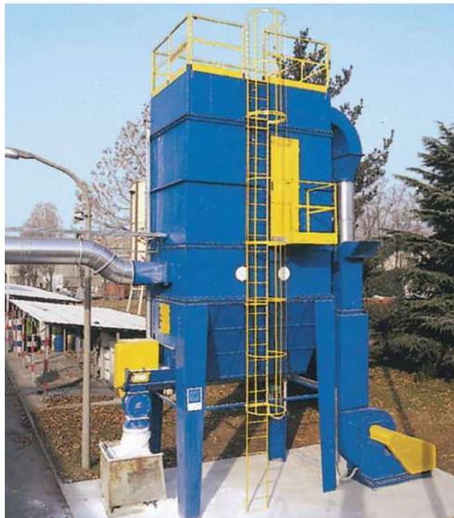
Figura 93: Filtro a maniche autopulente per la filtrazione di polveri di resina poliesteri. Portata d'aria 15.000 Nm 3 /h
