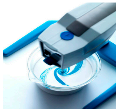
Figura 6: esempio di flocculazione con elico-agitatori su piccola scala.
