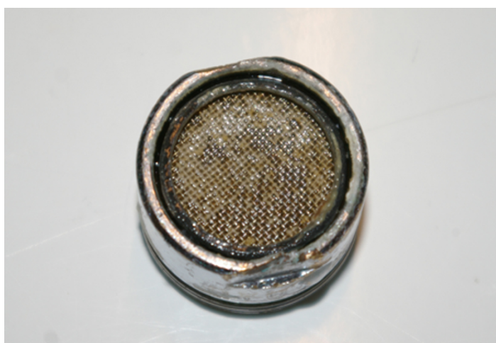
Figura 6: Rompigetto intasato a causa di incrostazioni causate da calcare.
