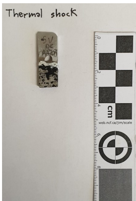
Figura 135: campione "5VDC" dopo il test di shock termico per la lega AA7075
