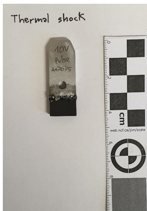
Figura 141: campione "10VPC" dopo il test di shock termico per la lega AA7075
