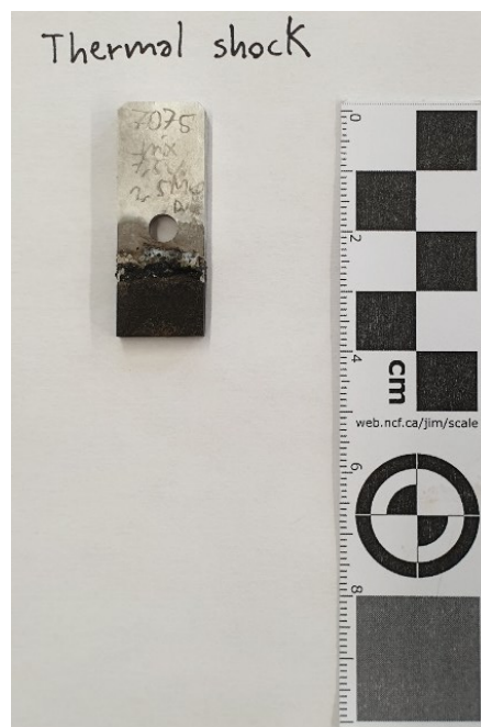
Figura 145: campione "7,5V2,5MoPC" dopo il test di shock termico per la lega AA7075
