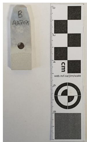
Figura 13: campione di lega di alluminio 7075 sottoposto a PEO usando la soluzione "base"
