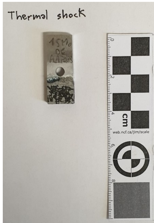
Figura 132: campione "15MoDC" dopo il test di shock termico per la lega AA7075
