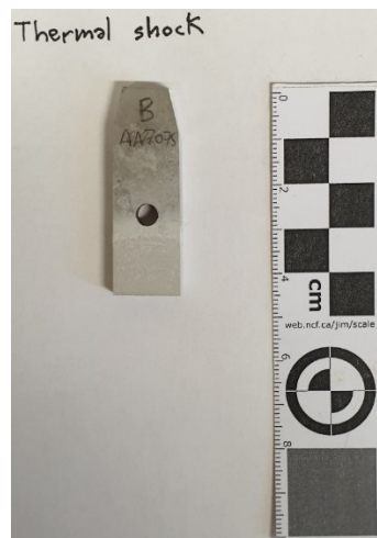
Figura 123: campione "base" dopo il test di shock termico per la lega AA7075
