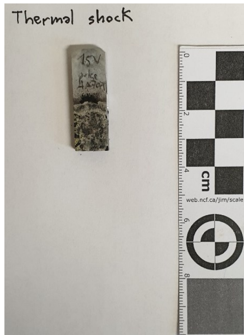
Figura 144: campione "15VPC" dopo il test di shock termico per la lega AA7075
