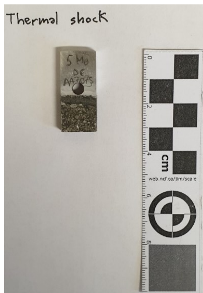
Figura 126: campione "5MoDC" dopo il test di shock termico per la lega AA7075
