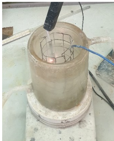
Figura 12: immagine del crogiolo in cui è visualizzabile la gabbia di acciaio al carbonio che svolge la funzione di catodo
