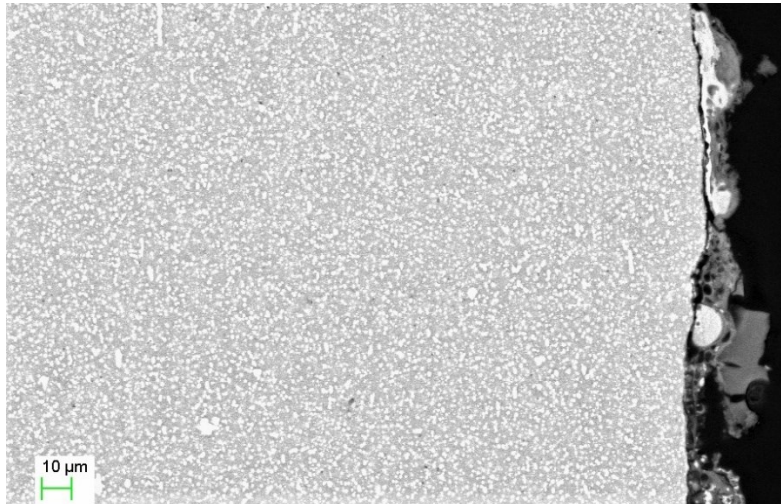
Figura 68: immagine della sezione trasversale ottenuta al SEM ad un ingrandimento di 1000X per il campione "15VPC" della lega di alluminio 7075
