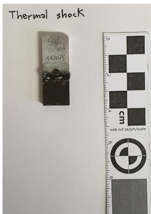
Figura 138: campione "5VPC" dopo il test di shock termico per la lega AA7075
