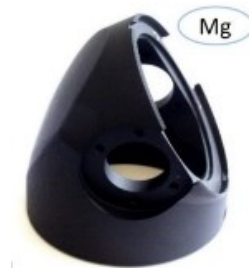
Figura 6: componente ottico in cui è stato realizzato un rivestimento PEO su lega di magnesio [12]
