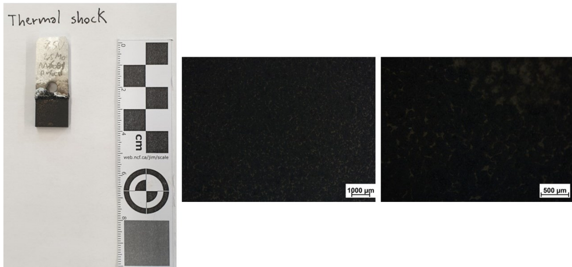
Figura 156: campione "7,5V2,5MoPC" per la lega di alluminio 6061; a sinistra l'immagine reale, al centro l'immagine ottenuta allo stereomicroscopio con ingrandimento 0,65X, a destra l'immagine ottenuta allo stereomicroscopio con ingrandimento 2X
