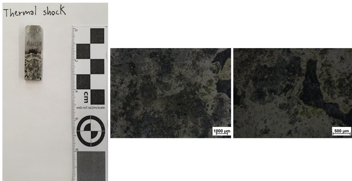
Figura 155: campione "15VPC" per la lega di alluminio 6061; a sinistra l'immagine reale, al centro l'immagine ottenuta allo stereomicroscopio con ingrandimento 0,65X, a destra l'immagine ottenuta allo stereomicroscopio con ingrandimento 2X
