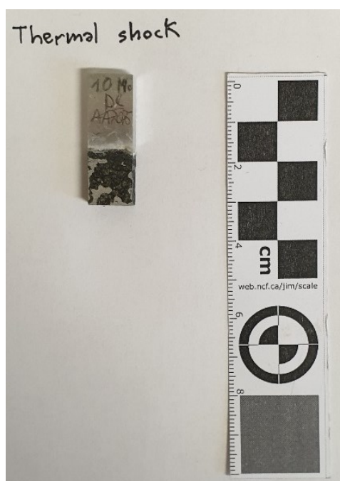
Figura 129: campione "10MoDC" dopo il test di shock termico per la lega AA7075
