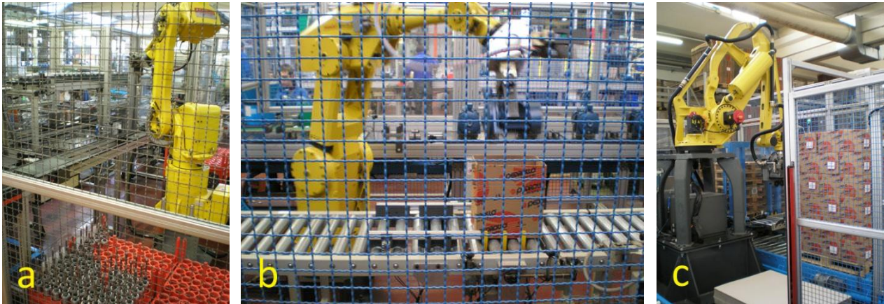
Figura 3.5a-b-c – Robot antropomorfi impiegati in azienda: a) inserimento dei rotorii negli statori; b) inscatolamento delle pompe; c) pallettizzazione dei prodotti finiti
