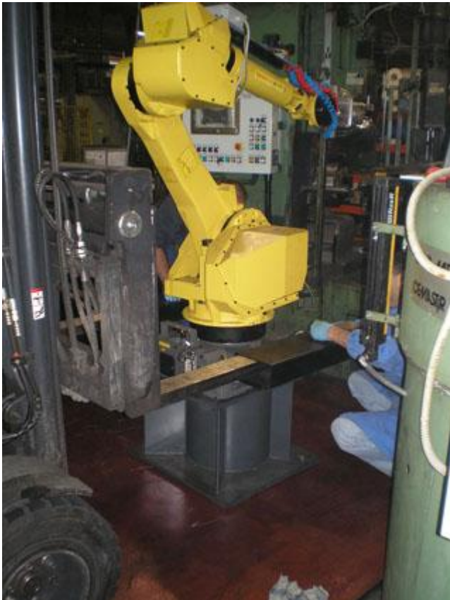
Figura 5.7 – Posizionamento del robot al centro della cella
