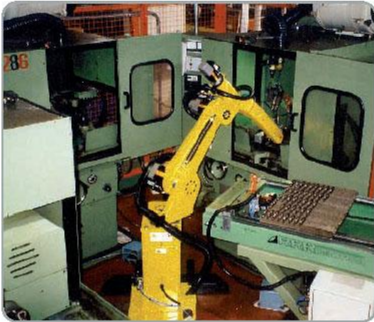
Figura 3.10 – Cella robotizzata per asservimento multiplo di macchine utensili con magazzino automatico verticale [9]
