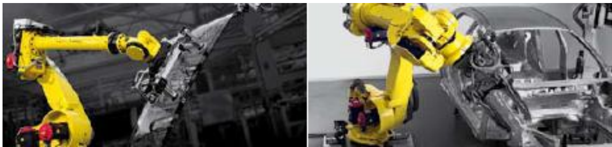
Figura 3.1 – Robot antropomorfi usati nell'industria dell'automobile: a sinistra un'operazione di manipolazione, a destra una saldatura [8]
