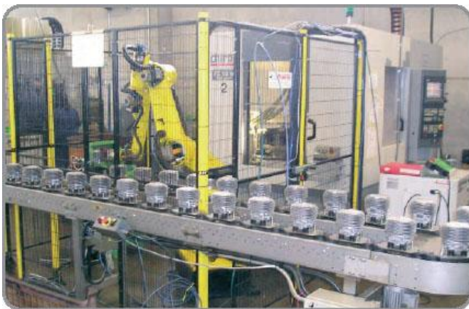
Figura 3.9 – Cella robotizzata per asservimento macchina utensile con magazzino a ricircolo di pallet [9]
