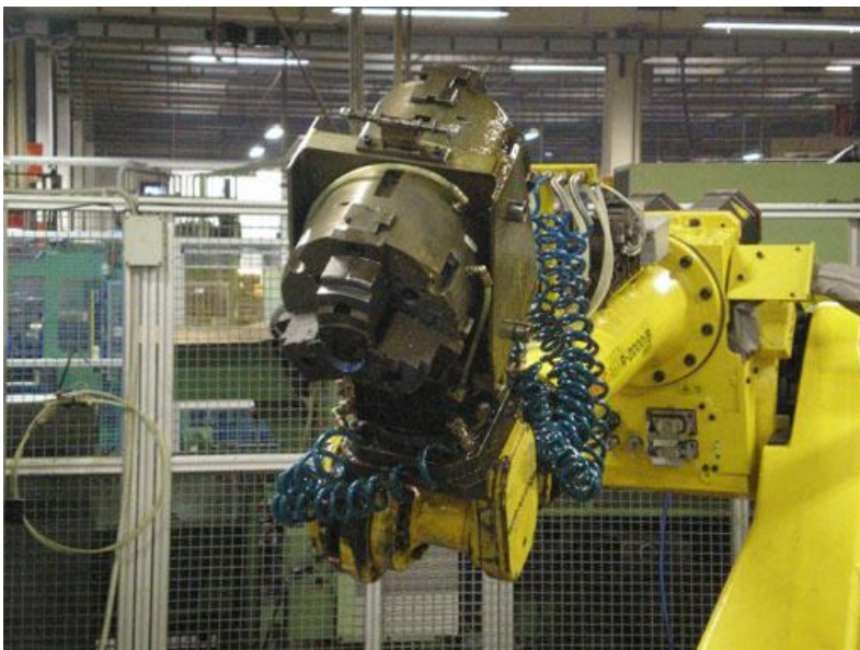
Figura 6.9 – Utensile doppio di presa con molle di riferimento
