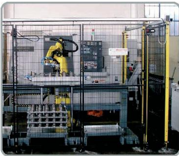
Figura 3.11 - Cella robotizzata per asservimento macchina utensile con magazzino automatico a vassoi [9]
