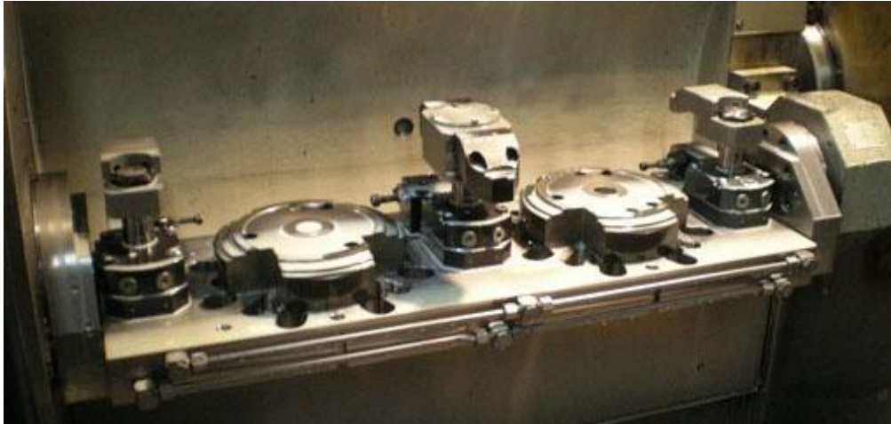
Figura 6.17 – Una delle due piastre del cdl, completa degli appoggi dedicati ai particolari in lavorazione
