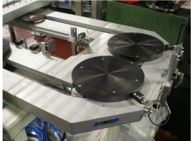
Figura 6.15 – Nastro definitivo, che permette la disposizione appaiata di due pallet .
