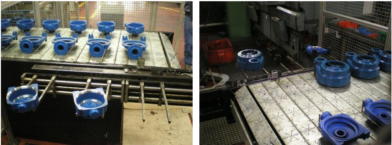
Figure 6.18-19 – Nastro di carico, con attrezzatura per l'appoggio temporaneo dei pezzi
