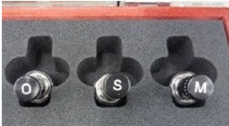
Figura 2.4: Impedenze Open, Short, Match del Cal Kit Cortesia di [13]
