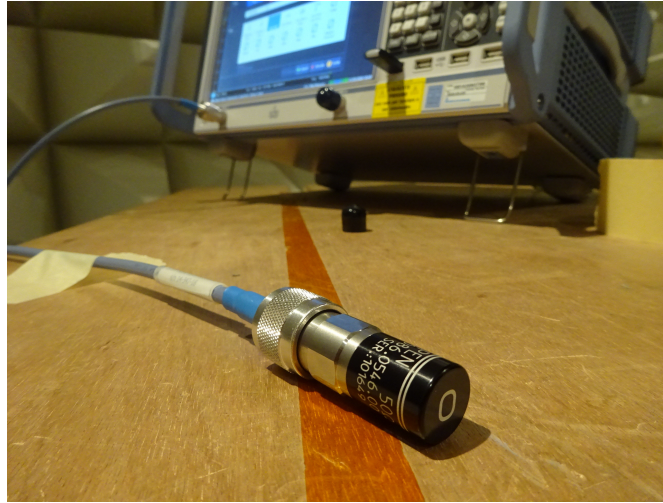
Figura 2.6: Terminazione connessa al cavo d'antenna Cortesia di [13]
