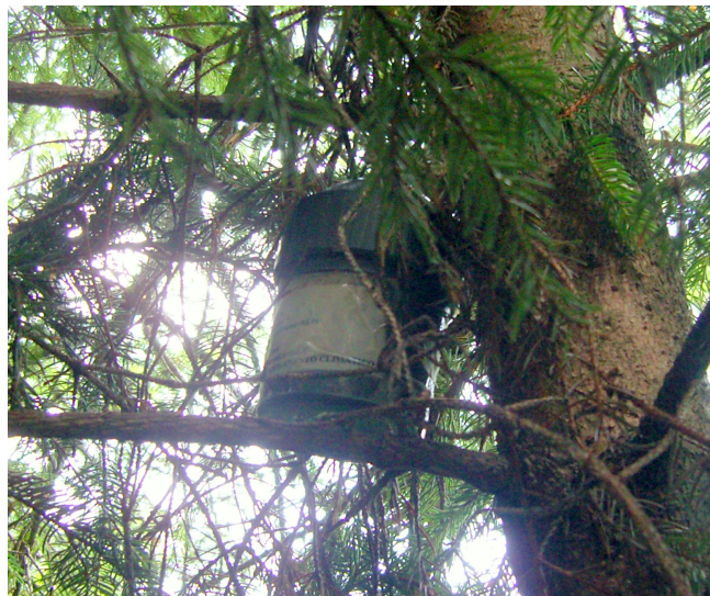
Fig. 9 Tipo di termometro registratore impiegato durante il monitoraggio delle temperature.
