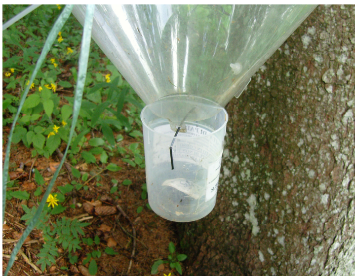
Fig. 7 Contenitore cilindrico destinato alla cattura degli insetti contenente una bustina di insetticida.
