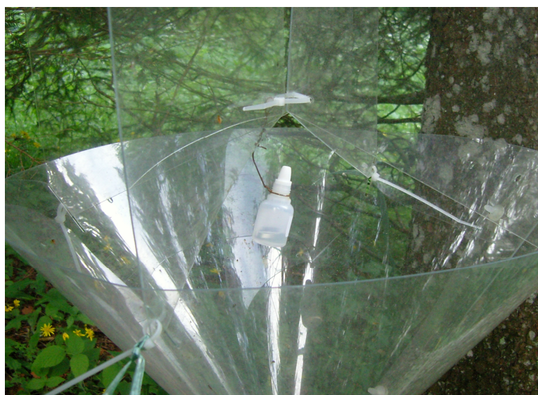
Fig. 8 Erogatore di etanolo usato nella trappola del tipo cross-vane.
