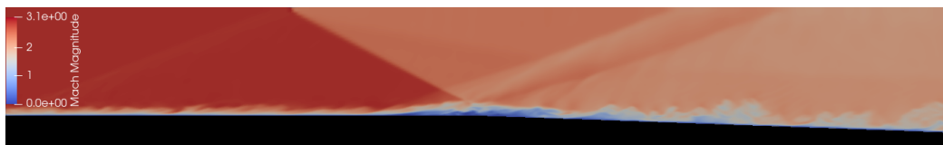
Figura 4.2.18: Campo scalare di Mach all'iterazione 200.000, si distinguono le 3 zone delimitate dalle onde d'urto e l'evoluzione e interazione dello strato limite. In nero il wall.
