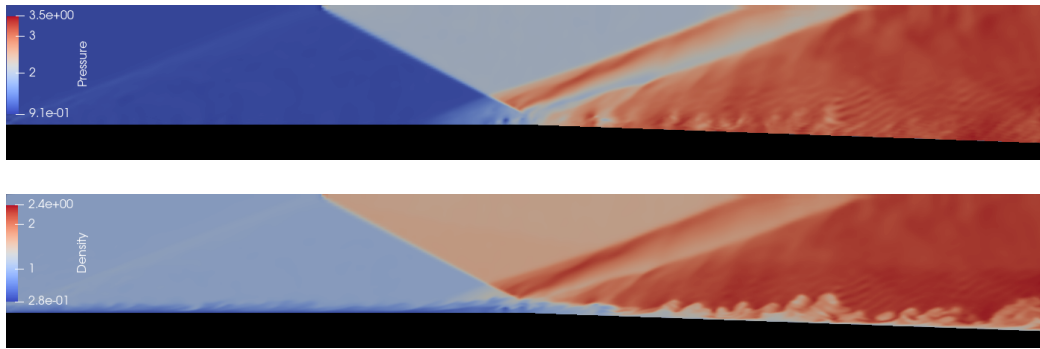
Figura 4.2.20: Campi scalare della pressione (in alto) e della densità (in basso) all'iterazione 200.000.
