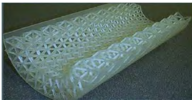
Figura 2.2: componente che presenta mesostruttura a cella octet-truss [1].
