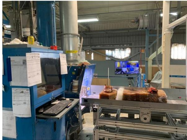
*Figura 15 - Camera di ingresso del Banbury. Nel lastro trasportatore è presente della gomma naturale non vulcanizzata (di colore marrone) assieme ad altri additivi*
