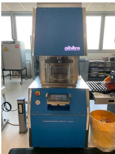
Figura 18 - Pressa industriale per la realizzazione di placchette vulcanizzate
