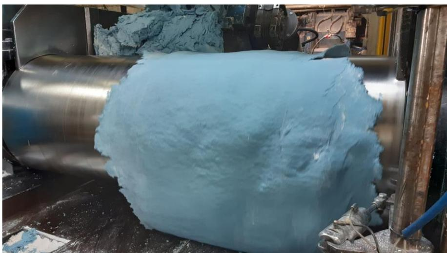
*Figura 39 - Prova di linea in lavorazione al mescolatore*
