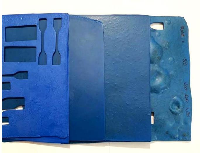
Figura 29 - Placchette ricavate dalla pressa dalle quali sono stati intagliati i provini. Da sinistra a destra abbiamo: EPDM Standard, Prova 2, Prova 4, Prova 6
