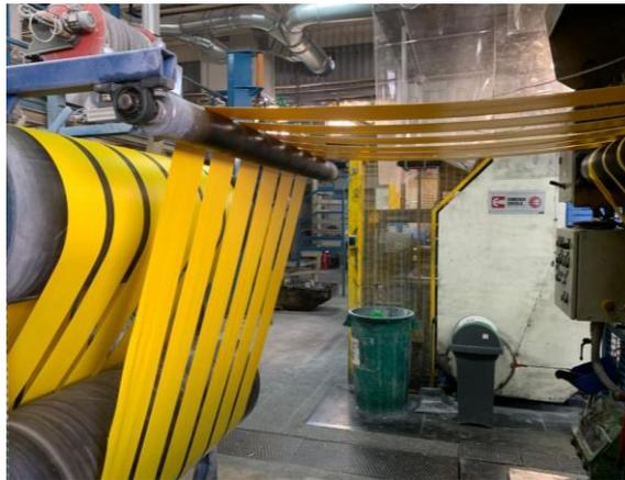
*Figura 17 - Calandra per la realizzazione di rotoli di gomma*
