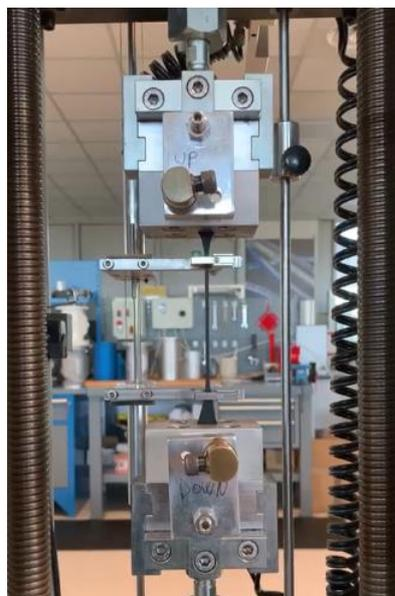
*Figura 25 - Dinamometro con provino ad osso di cane inserito per le misure di carico a rottura ed allungamento a rottura. Lo stesso setup è utilizzato anche per le misure di lacerazione.*
