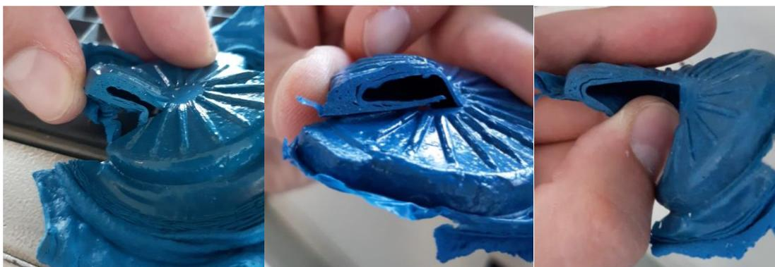
Figura 36 - Provini estratti dal reometro. Da sinistra a destra abbiamo: Prova 2, Prova 4, Prova 6
