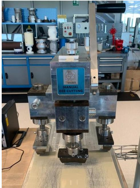
*Figura 19 - Fustellatrice a tre fustelle per intagliare provini differenti*
