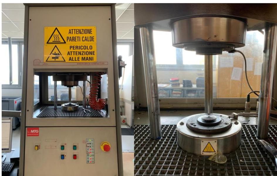
*Figura 26 - Reometro a rotore oscillante per ottenere le curve di vulcanizzazione*
