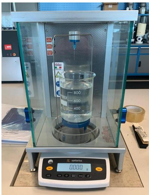
Figura 21 - Densimetro per misurare: massa volume e densità dei provini in esame
