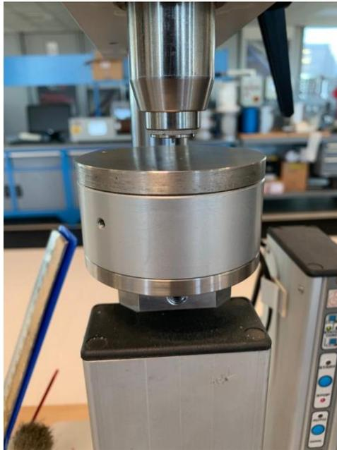
Figura 22 – Durometro con scala di misura Shore A
