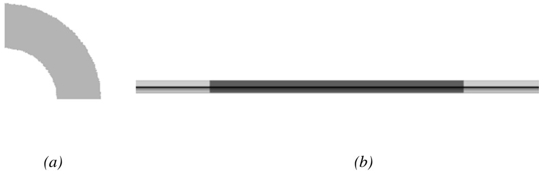
Figura 4.2: sezioni trasversale (a) e longitudinale (b) del modello solido su cui verrà operata la discretizzazione ad elementi finiti
