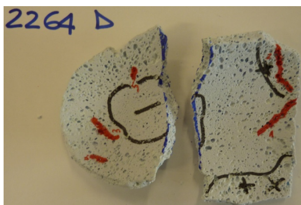
Fig. 6.7 Evidenza di linea primaria
