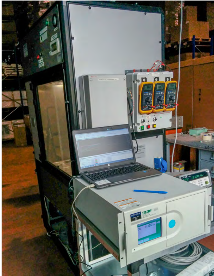
Figura 4.8: Foto della cabina presente in SIC durante una misurazione. In primo piano è ben visibile la strumentazione utilizzata per le misure, in secondo piano la cabina con la camera di sperimentazione illuminata.
