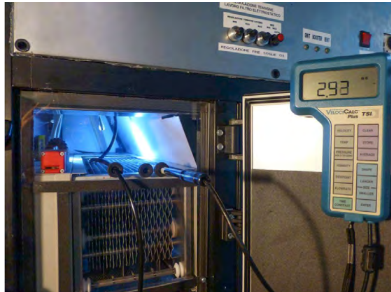
Figura 4.6: Esempio di strumentazione (anemometro a filo caldo) inserita nel vano del filtro attraverso il pannello in policarbonato trasparente.
