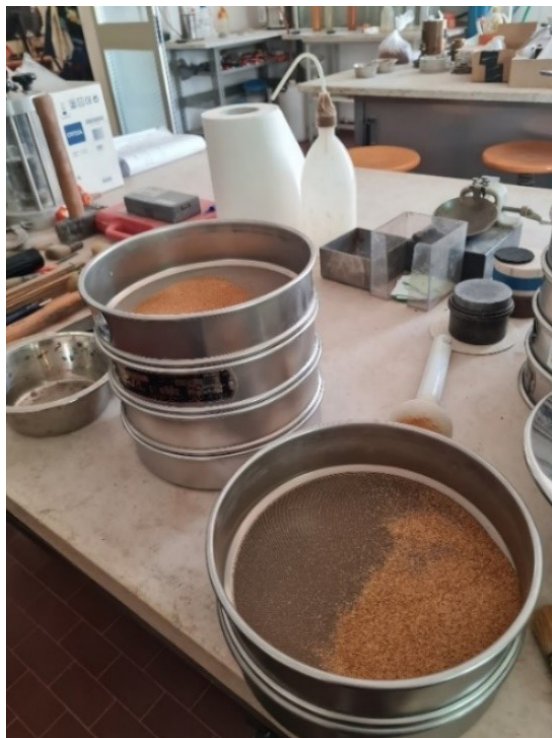
Figura 5.1- Vagliatura a secco del terreno
