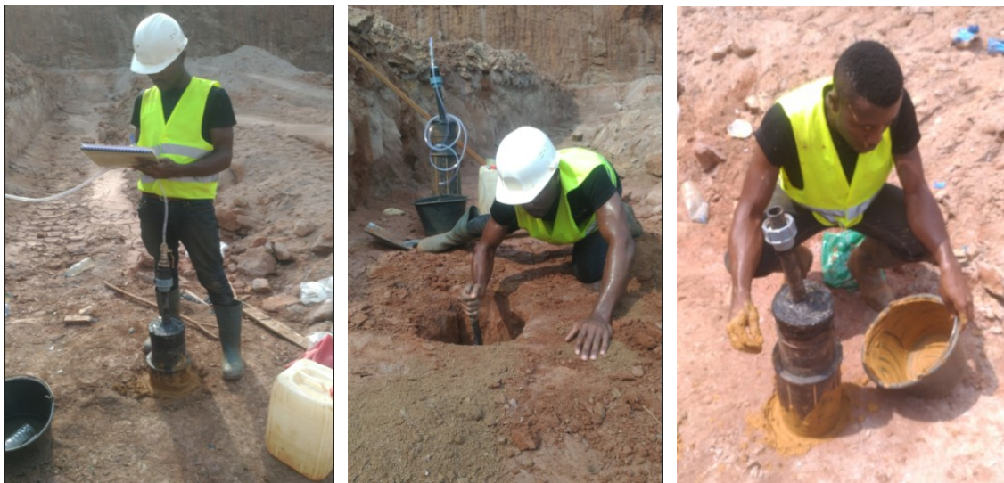
Figura 6.1, 6.2 e 6.3- Misura della permeabilità in situ
