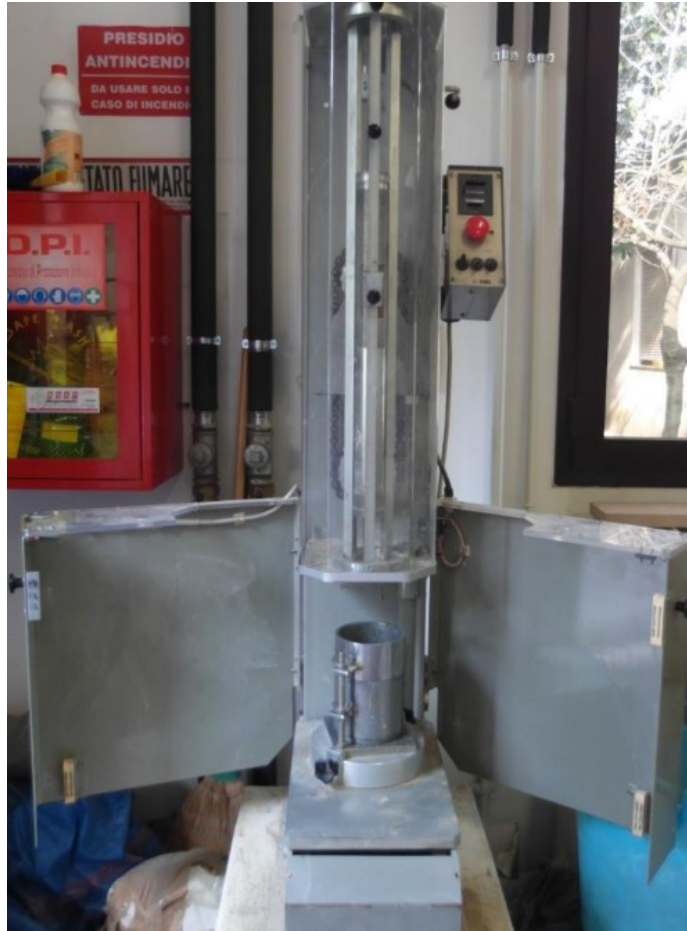
Figura 5.8- Compattatore meccanico utilizzato nel laboratorio di Padova
