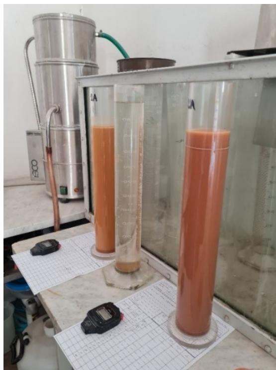
Figura 5.2- Vagliatura umida del terreno
