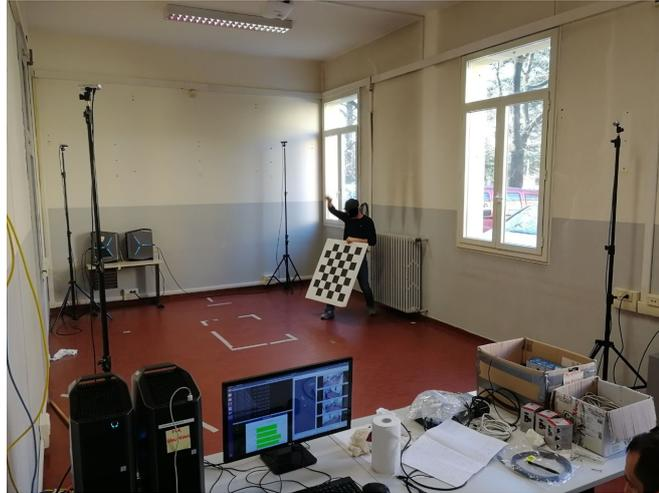
**Figura 5.4:** Setup delle videocamere Intel RealSense D455 utilizzate per la raccolta del dataset.
