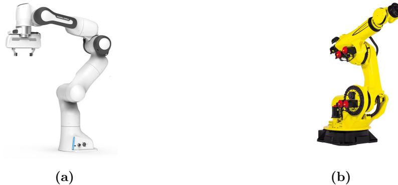
**Figura 1.3:** In figura (a) un cobot, mentre in figura (b) un robot industriale.
