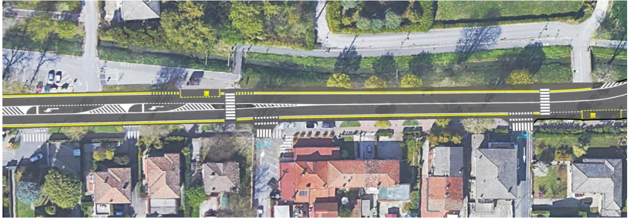
Figura 31 - Corsie di immissione e per la svolta a sinistra allo S.D.P. 2.
