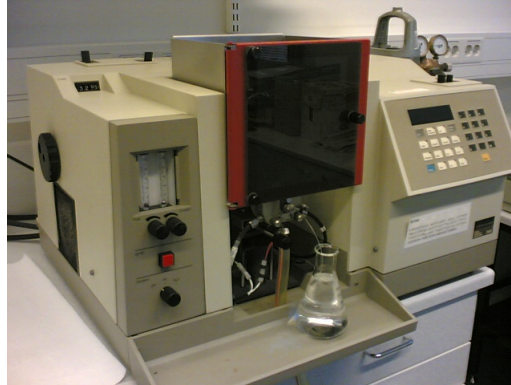
Figure 2.1.4: Strumento di laboratorio per misure di assorbimento atomico
