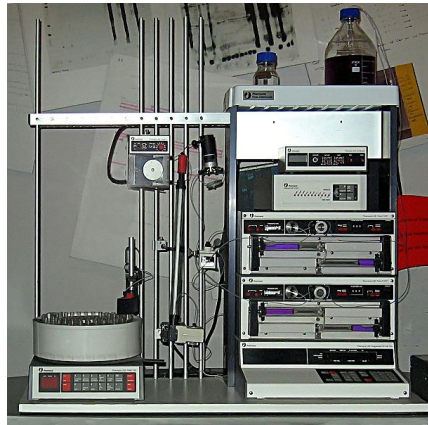
Figure 2.6.1: Un apparato per FPLC (fast protein liquid chromatography) esposto al Science Museum di Londra
