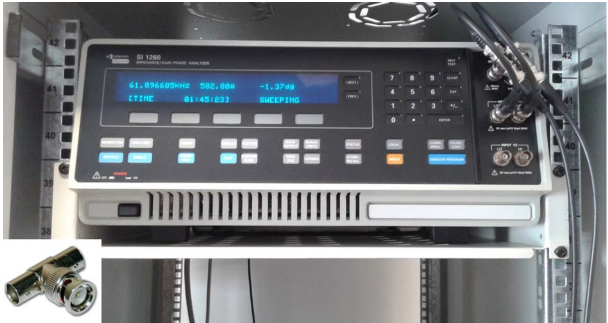
Figura 3.10: Lo strumento Solartron 1260A svolge entrambe le funzioni di potenziostato e analizzatore di risposta in frequenza. Nel box in basso a sinistra è riportato un connettore BNC a T.
