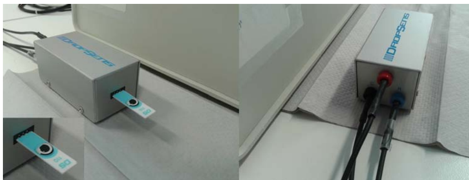
Figura 3.8: Interfaccia hardware DRP-DSC tra dispositivo elettrochimico e potenziostato CHI440A. È visibile un dispositivo DropSens DRP110 collegato e con sopra deposta una goccia di soluzione.
