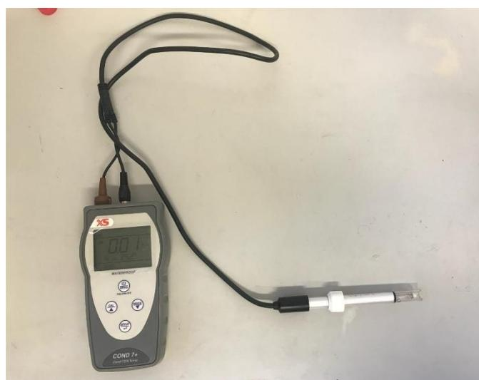
**Figura 23:** Conduttimetro utilizzato per l'esperienza di laboratorio
