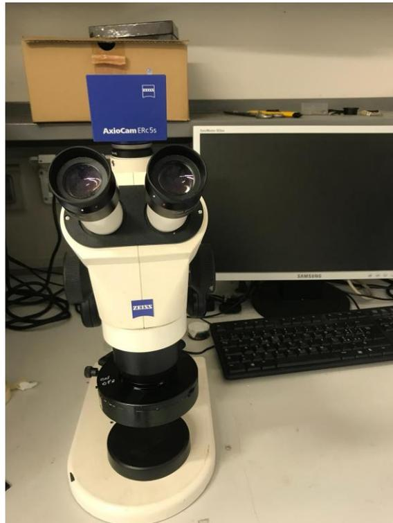
**Figura 15:** Stereomicroscopio utilizzato per l'esperienza di laboratorio
