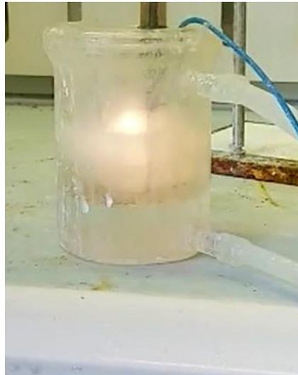
**Figura 3:** Rappresentazione di una scarica uniformemente distribuita sulla superficie dell'anodo
