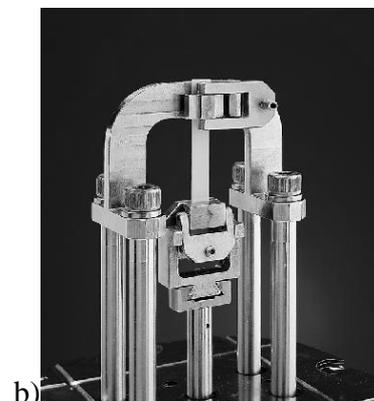
Figura 3.5 a)DMA presente in laboratorio e b)clamp utilizzata per le prove a trazione di film
