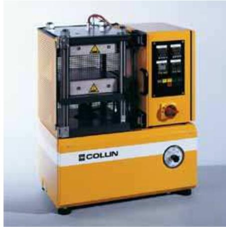
Figura 3.5 Pressa P200P utilizzata in laboratorio
