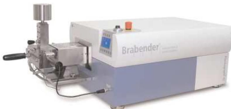
**Figura 3.9** Plastografo Brabender®
