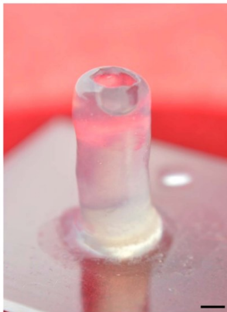
Figura 17. Struttura tubolare in alginato stampata in 3D, alta circa 13 mm, realizzata con soluzioni di alginato di sodio al 1,5% w/v e cloruro di calcio a 600 mM (6%) in acqua Millipore (barra di scala 2 mm).
