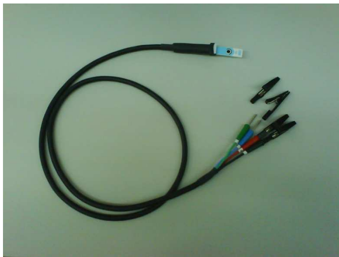
Fig. 1.14 Cavo di connessione dello SPE ai contatti del potenziostato
