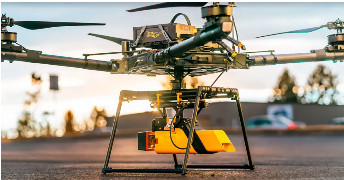
Figura 1.1: Esempio di quadricottero adoperato per LiDAR SLAM [3]
