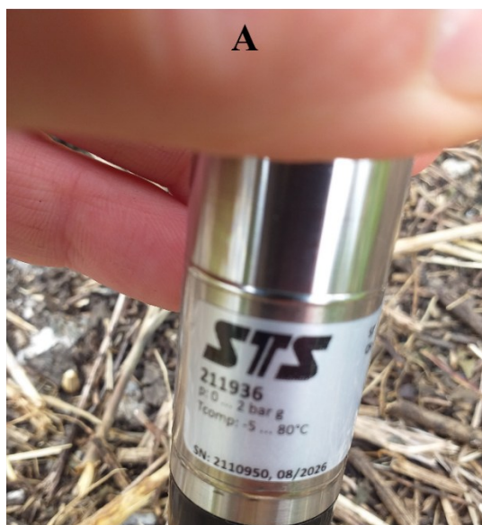
Figura 3.3.2.1: (A) Trasduttore di pressione da 2 bar e (B) sonda di temperatura.
