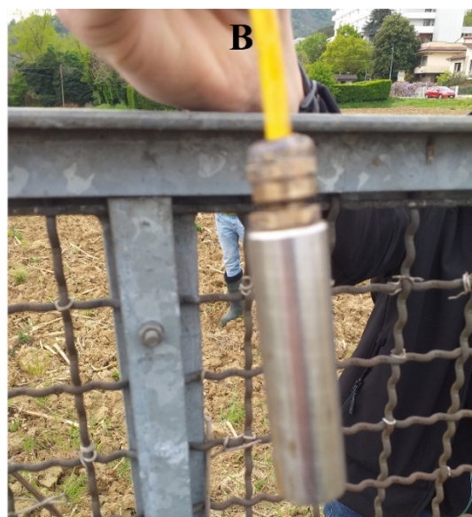
Figura 3.3.2.1: (A) Trasduttore di pressione da 2 bar e (B) sonda di temperatura.
