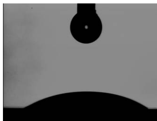
Figura 5.19: Fotogramma della misura dell'angolo di contatto per la prova 7 a potenza decrescente.
