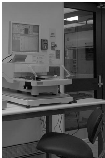
Figura 4.7: Immagine del profilometro a stilo utilizzato nella caratterizzazione.
