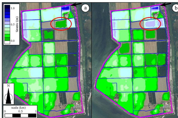
Figura 4.10 - Massimo tirante d'acqua sul dominio in seguito all'immissione di una portata di 40 \text{ m}^3/\text{s} per una durata di 10 ore dalla zona Nord-Est, considerando la resistenza del terreno isotropa (a) e anisotropa (b)
