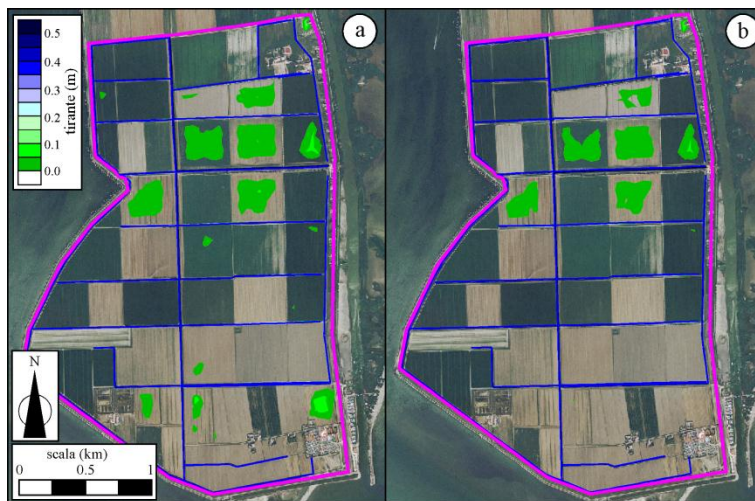
Figura 4.9 - Massimo tirante d'acqua sul dominio in seguito ad una precipitazione efficace di intensità pari a 5 mm/h per una durata di 5 ore, ipotizzando resistenza isotropa (a) del terreno e resistenza anisotropa (b)
