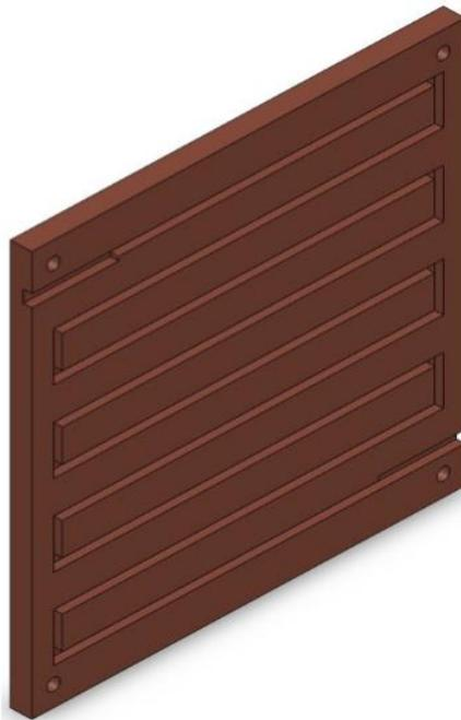
**Figura 2.19:** Piastra del riscaldatore in cui vi è il percorso per la resistenza elettrica [36].
