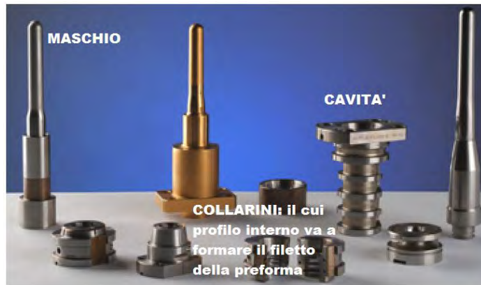
Figura 3.4 - Cavità, collarini e maschio: pezzi che vanno a formare lo stampo di una preforma.
