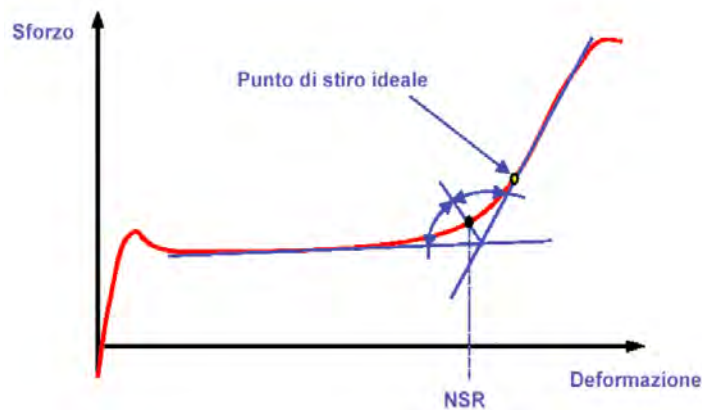
Figura 1.8 - Curva sforzo-deformazione del PET in cui è evidenziato l'NSR.
