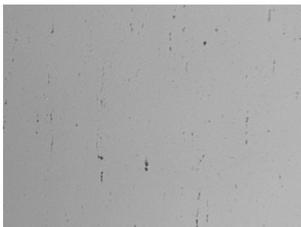
Figura 2a- Micrografie esemplificative dello stato inclusionale osservato, 100X
