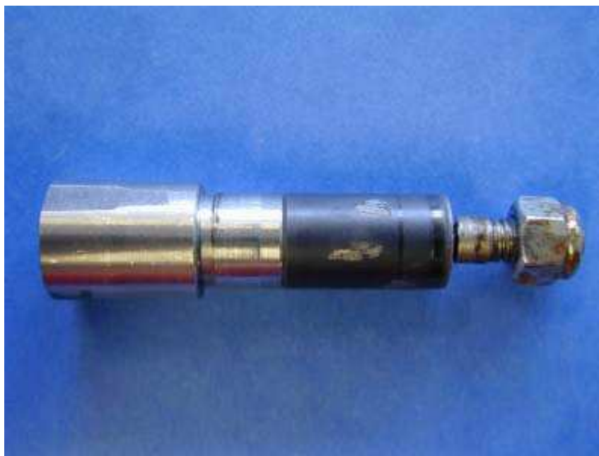
Figura 1- Aspetto visivo dell'albero fratturato
