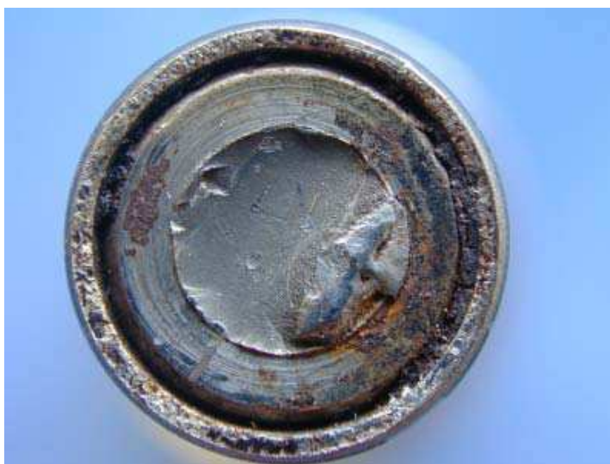
Figura 2-Aspetto macrografico della superficie di frattura, 8X.
