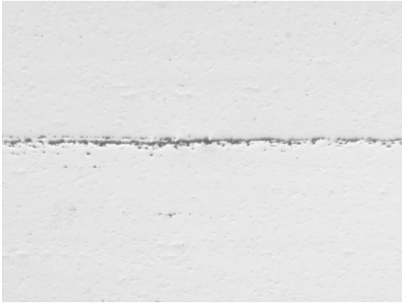
Figura 5a-Aspetto micrografico dello stato inclusionale osservato, 100X.
