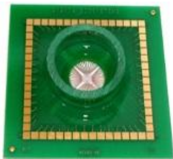
Figura 5.2: Fotografia del modello MEA60Au della Ayanda Biosystems.
