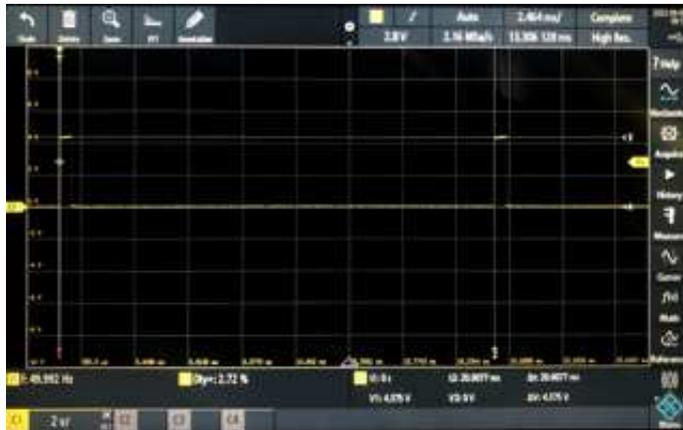
**Figura 3.6:** Segnale inviato ai servo per assumere un angolo di 0°
