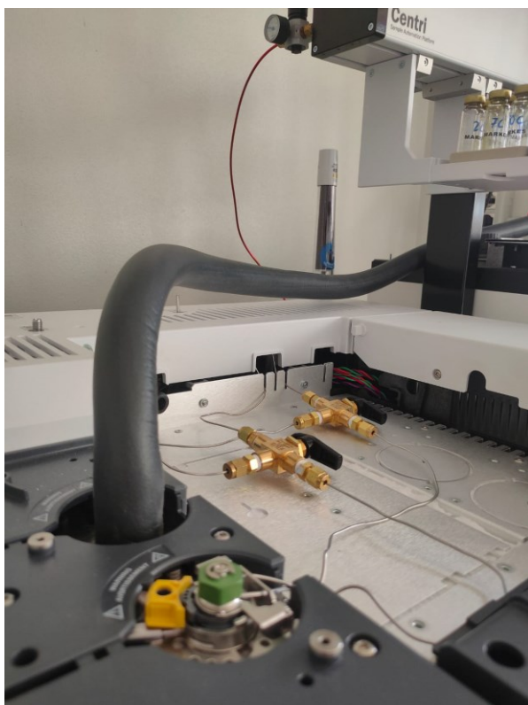
FIGURA 25 TRANSFER LINE IN USCITA DAL TD (IN ALTO NELLA FIGURA) E IN INGRESSO NEL BACK INLET DEL GC (IN BASSO NELLA FIGURA).
