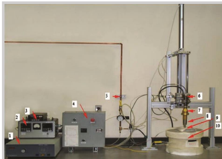
Figura 3.2: Attrezzatura utilizzata per quantificare il fenomeno della metallizzazione. [1]generatore ultrasonico, [2]comandi per fornace elettrica, [3]indicatore della temperatura del fluido, [4]dispositivo ad azionamento pneumatico, [5]apertura d'aria, [6]trasduttore, [7]ripetitore, [8]antenna, [9]provino, [10]forno [19] .
