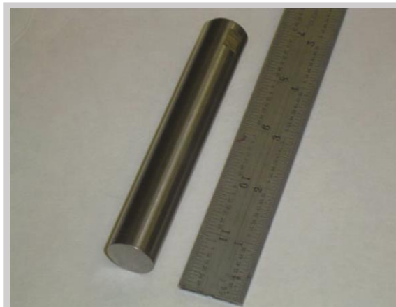
Figura 3.1: provino in acciaio utilizzato nei test per metallizzazione con vibrazioni ultrasonore [19] .
