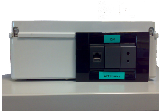
Figura 8.5: Dettaglio sulla presa eth, il bottone d'accessione e la presa di corrente
