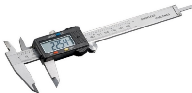
Figura 10. Calibro digitale per la misurazione del diametro e altezza del frutto.
