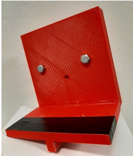
Figura 5.5: Staffa di adattamento per ancorare la scocca al banco prova.
