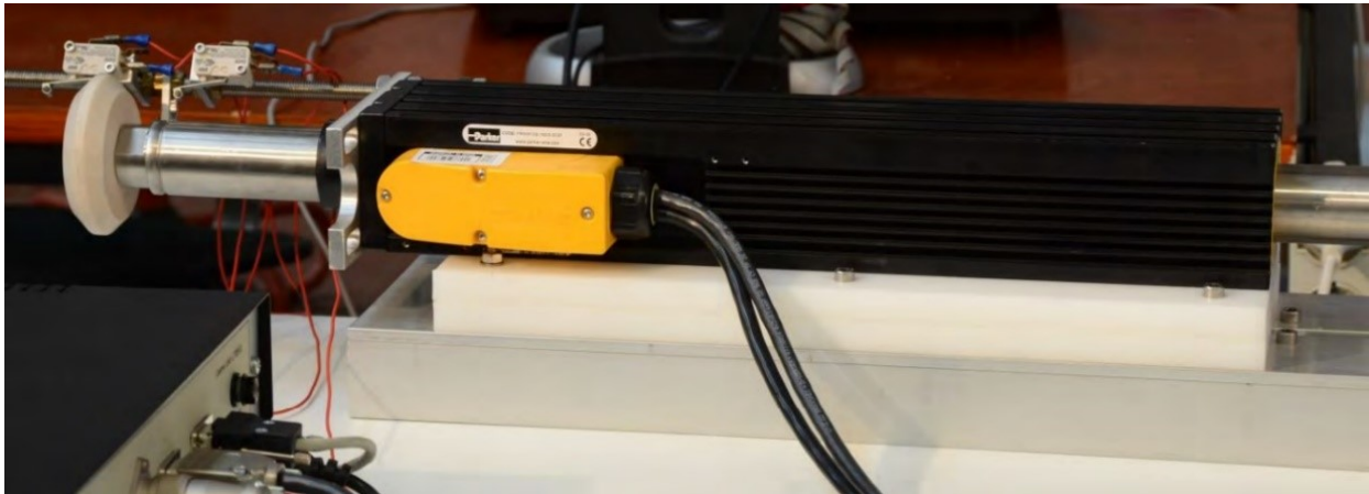
Figura 6.2: Attuatore elettromagnetico lineare Parker PRA 3810S.
