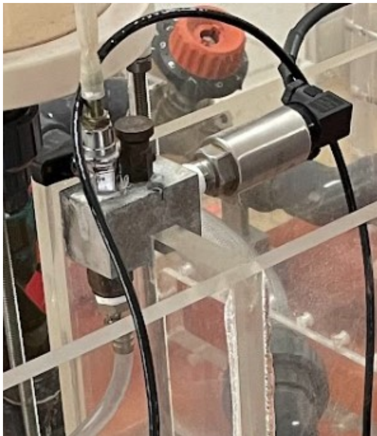
Figura 6.9: Sensore di pressione Piezotronics Serie 1502.
