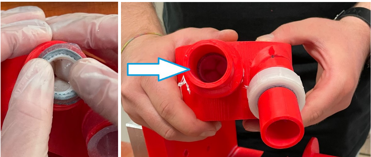
Figura 6.10: Posizionamento della valvola protesica (a sinistra) e valvola inserita nel raccordo di entrata (a destra, freccia bianca).
