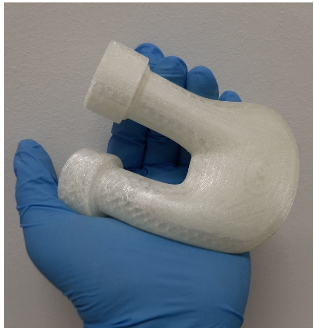
Figura 5.6: Anima per la nuova camera ventricolare: fase di stampa (a sinistra) e prodotto finito (a destra).
