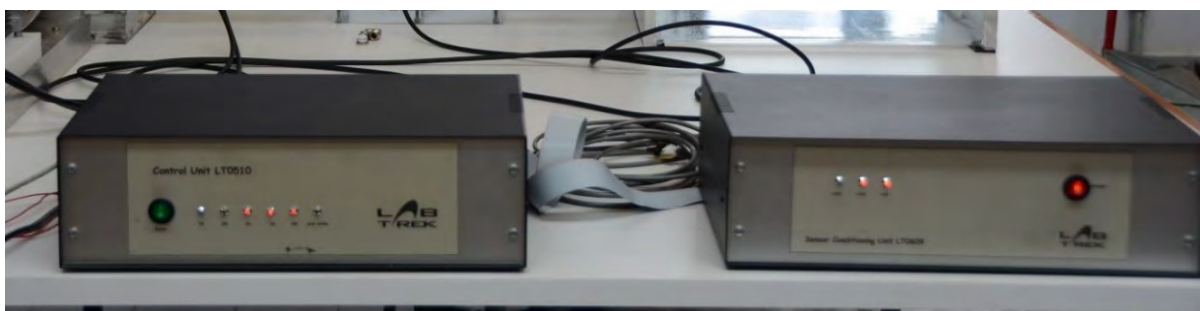
Figura 6.3: Unità di controllo LT0510 e Sensor Conditioning Unit LS0609 (LabTrek S.r.l.).
