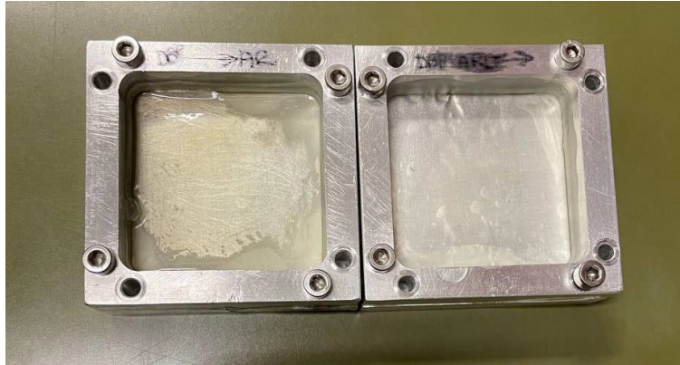
Figura 3.2: Esempi di membrane ibride ottenute con la tecnica di "solvent casting".
