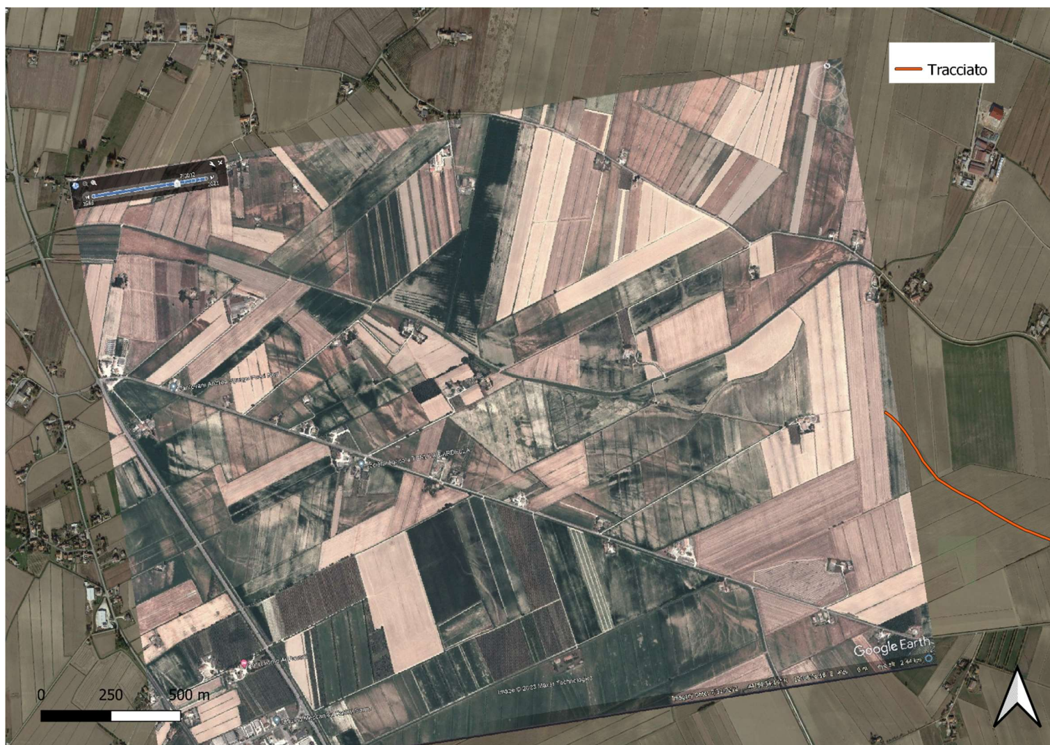
Figura 9: evidenze di paleoalvei e divagazioni fluviali che possono aver cancellato le tracce stradali nella zona a sud di Corbola. (Elaborazione GIS, immagine da Google Earth).
