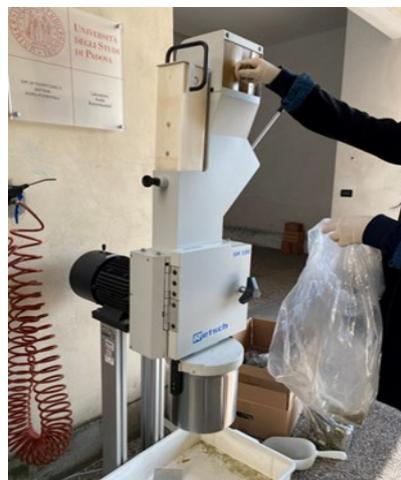
*Figura 14: produzione delle farine di canapa attraverso la macinazione delle frazioni botaniche effettuata con l'utilizzo di un mulino Retsch SM100. Foto scattata durante i lavori.*
