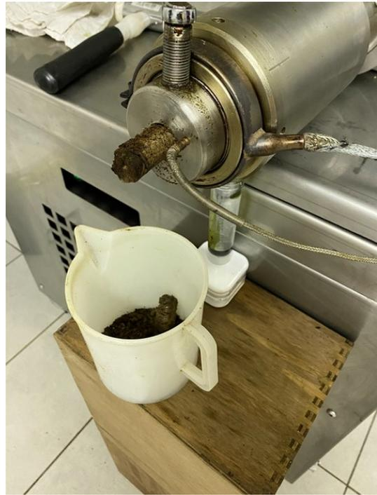
*Figure 12 (a sinistra) e 13 (a destra): estrazione dell'olio dai semi di canapa (Figura 12). Raccolta del pannello di canapa in seguito all'estrazione dell'olio (Figura 13). Foto scattate durante i lavori.*
