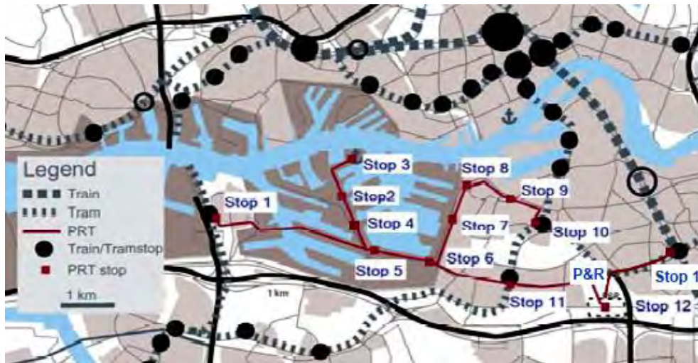
Figura 41 Reti di PRT, treno e tram nell'area di studio (Li, Chen, Li, van Zuylen, & van Arem, 2010)
