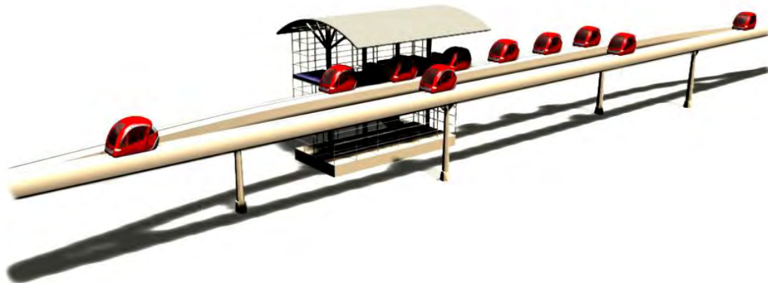
Figura 29 Schema di stazione off-line (personalrapidtransit.com s.d.)
