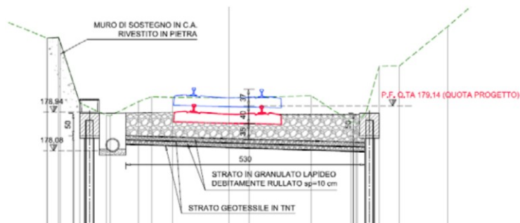
Figura 82 – Sezione in vicinanza all'imbocco della galleria
