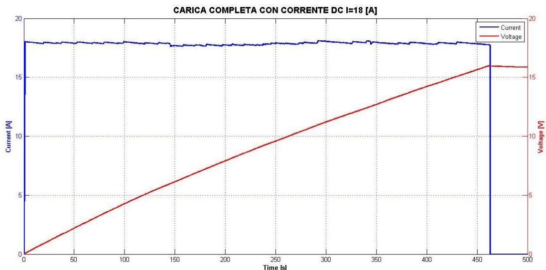
Figura 3.5 Carica a corrente costante I_{DC}=18 [A]
