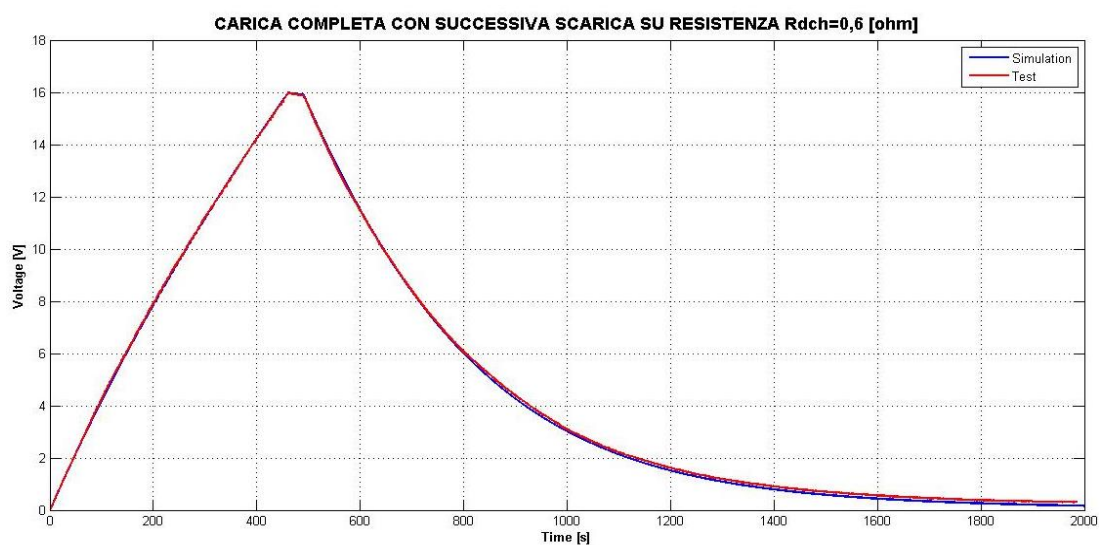
Figura 3.44 Test di scarica su R_{dch}=0,6 [\Omega]
